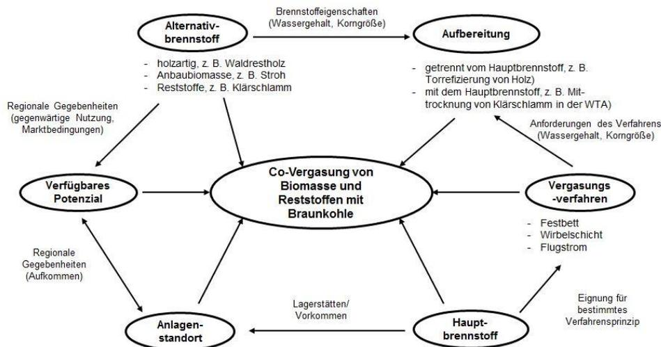
**Abb. 3.10 Einflussfaktoren auf die Co-Vergasung von Biomasse und Reststoffen mit Braunkohle**
